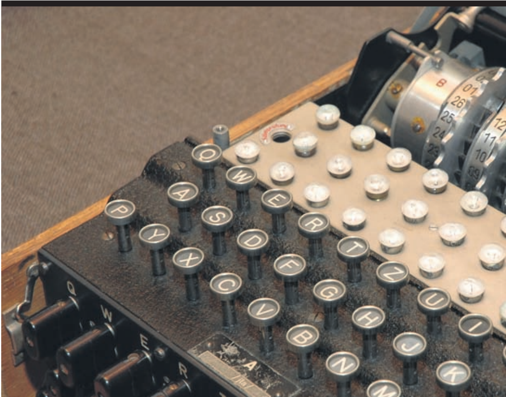
Kein X für ein U. Bei der Chiffriermaschine «Enigma» dreht mit jedem Tastendruck eine Walze, sodass sich der Code ständig ändert. Foto Dominik Landwehr
